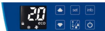
En analysant la fréquence d'ouverture de porte(s) ainsi que les fluctuations de la température à l'intérieur de la cellule, le contrôleur électronique détermine les cycles de dégivrage et le temps de fonctionnement éco-énergétique du compresseur. Si la porte est peu ouverte ou pas du tout pendant de longues périodes, le contrôleur se met automatiquement en modalité ECO, conservant de cette façon jusqu'à 30% de la consommation énergétique.
